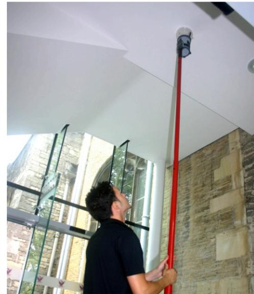
**testifire**® ist das weltweit erste 3-in-1-Brandmelderprüfgerät mit optionalem Kommunikationsmodul und Protokollierfunktion. Durch sein Design ermöglicht das Melderprüfgerät die schnelle und effiziente Prüfung von Rauch-, Wärme- oder CO-Meldern und kann mit diesen Stimuli sequentiell oder gleichzeitig prüfen. Daher ist er auch perfekt für die Prüfung von Multisensor-Meldern geeignet.
